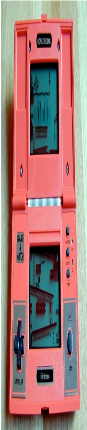
Die Multi Screen-Konsole aufgeklappt. Zwischen den beiden Bildschirmen kann man gut das Verbindungs-Flachbandkabel erkennen. (Bild: André Eymann)
